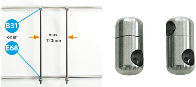
Die Gelenkhalter müssen vor der Montage aufgesteckt werden; Anzahl festlegen. Wir empfehlen einen max. lichten Abstand von 120mm. Die Winkelhalter E68 sind für die Befestigung von senkrechten Stangen an Brüstungsgeländern geeignet.
