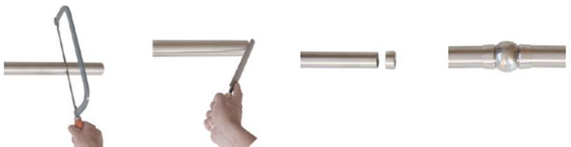
1. Rohr mit Flex oder Metallsäge auf Länge schneiden
